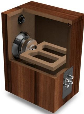
Für die perfekte Stabilität aller Komponenten sorgt das massive Gehäuse aus mitteldichter Faser (MDF). Zentral hinter dem Tiefmittelton-Chassis ist eine zusätzliche Versteigung angebracht, an der sich das Chassis abstützen kann.
