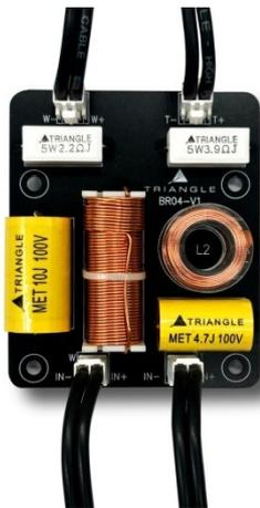
Die akustische Trennung der beiden Chassis übernimmt eine Frequenzweiche, deren Bauteilequalität in dieser Klasse unerreicht ist. Die perfekte Abstimmung der Lautsprecherchassis zueinander schon in der Entwicklung erlaubt einen sehr sanften Eingriff der Filterschaltung, was in perfektem Phasenverhalten und in einem absolut bruchlosem Übergang der beiden Chassis resultiert.
