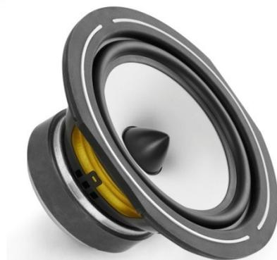
Der 16cm-Tiefmitteltöner ist direkt aus der ESPRIT EZ-Linie abgeleitet und besteht, charakteristisch für Hochwirkungsgradlautsprecher aus Papier. Der mitschwingende Phase-Plug sorgt für eine saubere und unter allen Bewegungsumständen gleichbleibende Abstrahlung der mittleren Frequenzen. Der sehr kräftige Magnetantrieb und die stark gespannte Zentrierspinne (im Bild gelb) sorgen für große Kontrolle.
