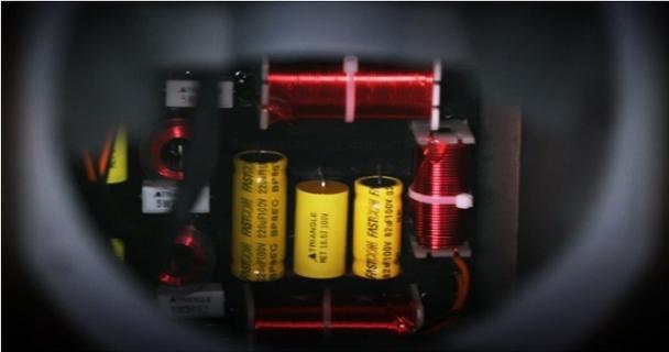
Um jedem Chassis einen optimalen Arbeitsbereich zuzuweisen verfügt die COMÈTE 40th über eine Frequenzweiche mit höchst selektierten Bauteilen. Jede Komponente wird sorgfältig ausgewählt: Luftkernspulen, MET-Kondensatoren und Keramikwiderstände.
