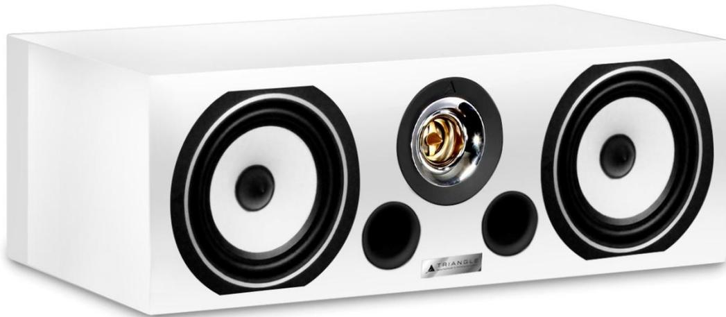
Das Gehäuse des Voce EZ ist im Innern mehrfach versteift. Die Tiefmitteltöner arbeitet auf ein tief abgestimmtes Bassreflexsystem. Dies erweitert die erreichbare untere Grenzfrequenz beträchtlich. Das Bassreflexsystem wird mit zwei eher kleinen Öffnungen realisiert. Dies verbessert das Ansprechverhalten des Systemes bei geringen Lautstärken.
