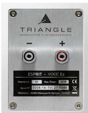
Das Anschlussterminal der Voce EZ ist aus antimagnetischem Aluminium gefertigt. Die Anschlussbuchsen nehmen Kabelschuhe, 4-mm-Stecker oder auch blankes Kabel auf. Zur Steigerung der Kontaktsicherheit bei Verwendung von 4-mm-Steckern (auch Bananenstecker genannt) können diese durch Anziehen der Mutter arretiert werden.
