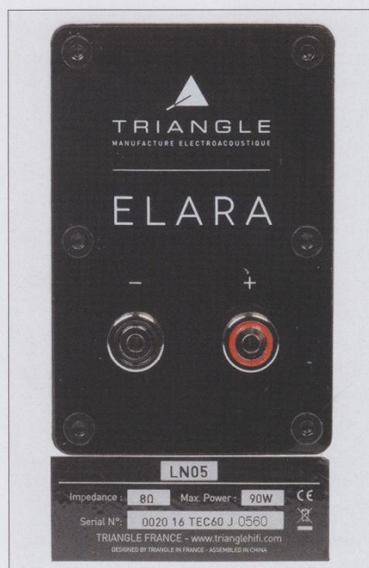
Gut zu erkennen: die Impedanz ist mit 8 Ohm angegeben
