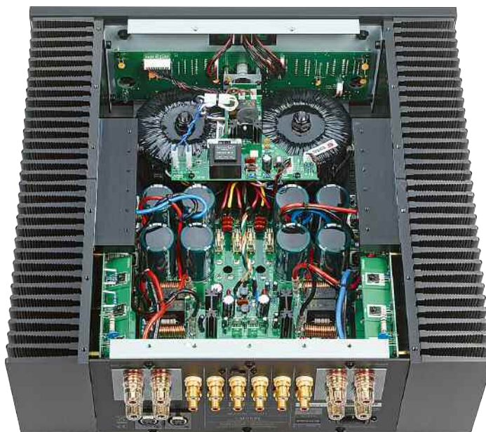
Doppelmono-Konzept mit zwölf (!) bipolaren Leistungstransistoren je Kanal, fetten Ringkerntrafos, hoher Siebkapazität und satten Kühlkörpern. Resultat: über 1200 Watt Impulsleistung pro Kanal...
