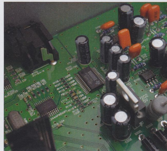
Der Burr-Brown-Chip wird nur bei der Wiedergabe von CDs genutzt, alle anderen Eingänge verwenden zur Wandlung einen Wolfson-DAC
