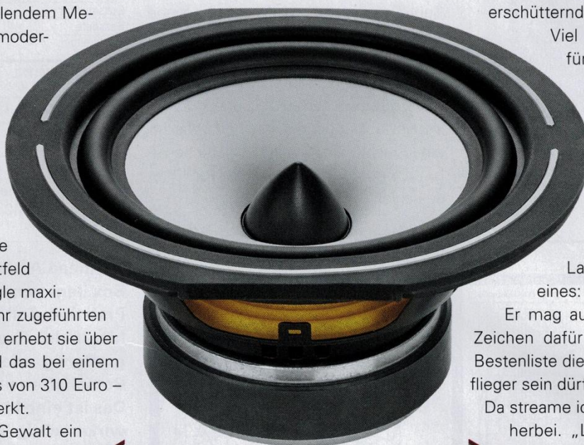
PAPIER TRIFFT SEIDE: In der Tiefe färbt Triangle die Papiermembran silbern ein, in der Höhe schwingt eine Gewebekuppel.
