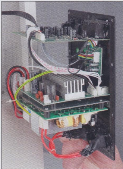
Die moderne Elektronik enthält eine Class-D-Zweikanalendstufe und eine aufwendige Signalverarbeitung mit DSP und Phonostufe
