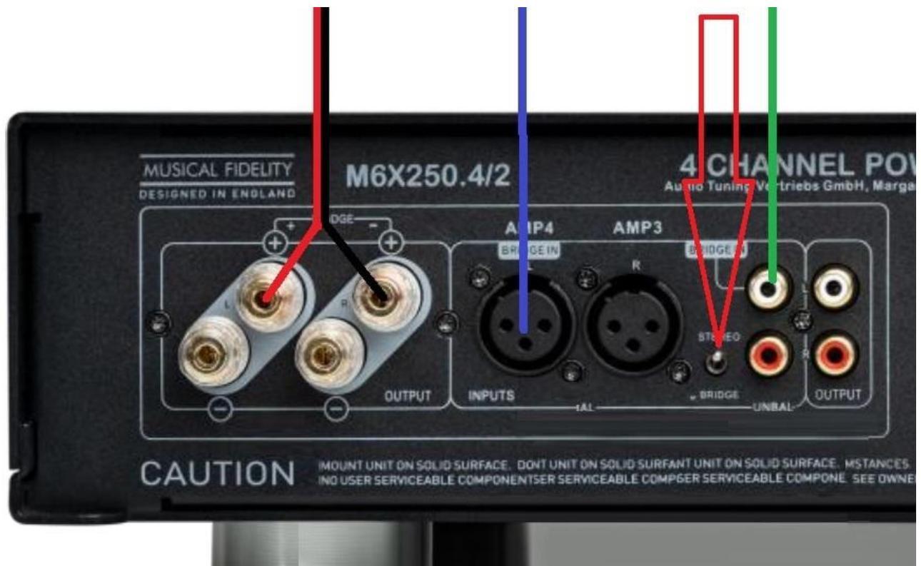
Schließen Sie das Eingangssignal an den Eingang links der jeweiligen Sektion.
