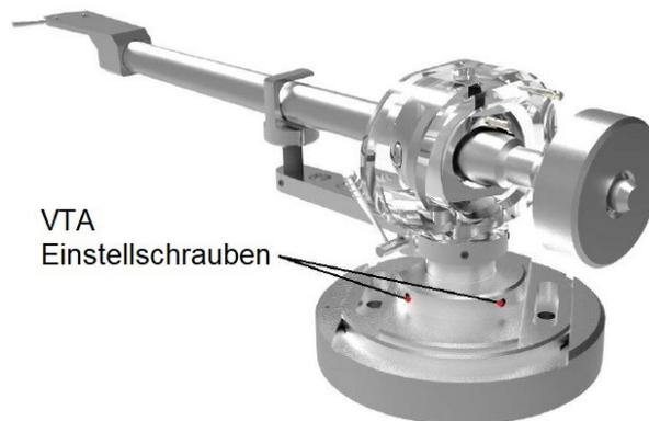
Bewegen Sie nun den Tonarm vertikal an der Aufhängung, bis dieser parallel zur Oberfläche einer aufgelegten Schallplatte befindet. Dazu die Nadel in die Rille senken und das Tonarmrohr mit der Schallplatte in Parallelität bringen. Danach die beiden Madenschrauben wieder festziehen.
