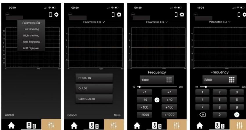
„Parametrischer EQ“ ermöglicht Ihnen die Feinabstimmung der Frequenz, die Sie beim Hören verbessern möchten. Zum Beispiel eine als empfindlich erkannte Frequenz, die um die Resonanzfrequenz des Ohrs herum liegt, oder eine zu dämpfende Resonanz bei einem Instrument, einer Stimme usw. Diese Einstellung betont oder dämpft den wiederhergestellten Pegel dieser Frequenz.
