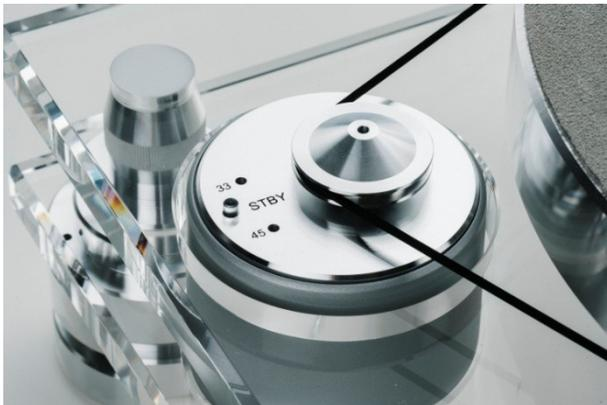
Der auf dem unteren Acrylchassis dämpfend gelagerte Motor hat außer über den Riemen keinerlei Kontakt zum oberen Acrylchassis, an dem die für die Wiedergabe verantwortlichen Teile (Teller mit Lager und Tonarm) montiert sind.
