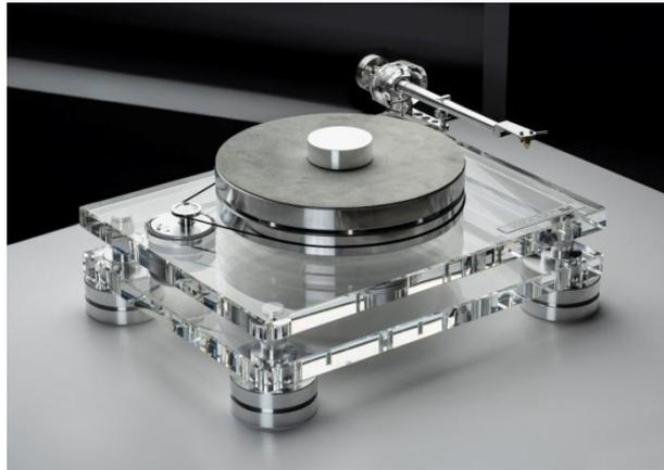
Der M8xTT setzt gleich auf zwei Acrylchassis. So kann der Antriebsmotor ohne physischen Kontakt zur spielenden oberen Ebene platziert werden. Gleichzeitig sorgt die Gesamtkonstruktion mit ihrem cleveren Design dafür, dass der sensible Abtastprozess des Tonabnehmers durch nichts beeinträchtigt wird.
