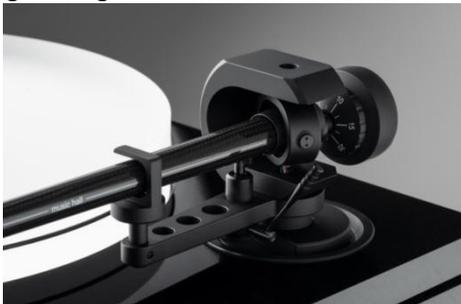
vermieden. Das konisch geformte Tonarmrohr vermeidet stehende Wellen. Vier in hochpräzisen, schweizer Kugellagern der Qualität ABEC 7 gelagerte Edelstahlspitzen bilden die invertierten Tonarmlager.
