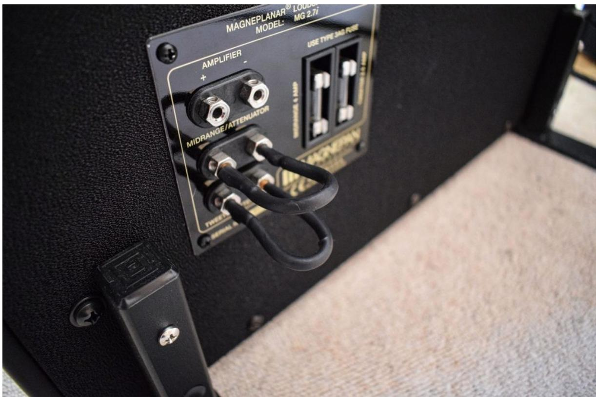
Sieht zwar aus wie ein Tri-Wiring-Anschluss, zeigt aber nur die Möglichkeit der pegelmäßigen Anpassung. Rechts die Sicherungen für Tiefmittel- und Hochton-Panel (Foto: H. Biermann)
