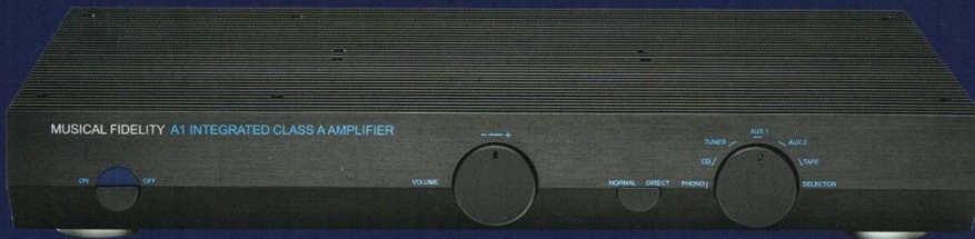
Zwischen Quellenwahl und Volumeregler sehen wir den Direct/Normal-Schalter. Damit boosten wir die Verstärkerleistung um weitere 10dB und fügen einen Hauch Verzerrung hinzu
