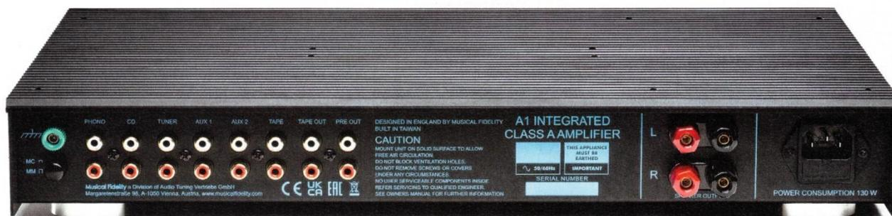
Das Gehäuse als Kühlkörper führte zum Spitznamen „Waffleisen“: Class A, fünf Hochpegeleingänge, Phono-MM/-MC umschaltbar, Pre Outs, ein Ausgang, ein Paar Lautsprecherausgänge – that’s it.
