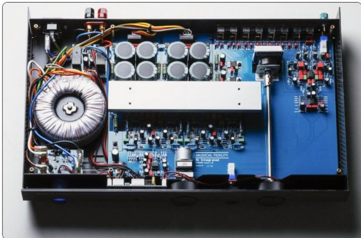
Der saubere Aufbau des A1 mit »Dual Mono Split Rail«-Transformator. Der große Aluminiumblech in der Mitte stellt die Verbindung zum wärmeableitenden Außengehäuse her.
