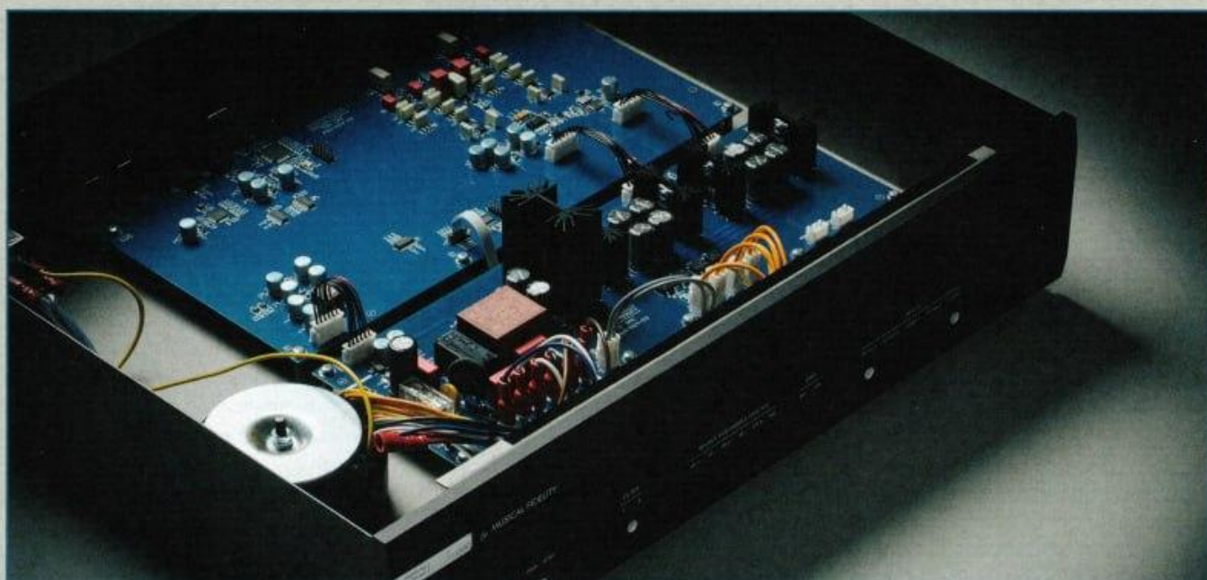
Der Super Silent Power Transformer eliminiert Störungen und Transformatorbrummen. EMI-Filter, nebst eines DC-Blockers, reduzieren elektromagnetische Strahlung und sorgen für niedriges Grundrauschen.
