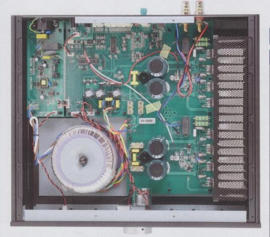
Im Gegensatz zum M6si nehmen beim M5si alle Bauteile auf einer gemeinsamen Platine Platz. Was bleibt, ist der Doppel-Mono-Aufbau mit zwei getrennten Endstufenzügen und einer Vorstufe. Die vier Transistoren pro Kanal sitzen alle rechts auf einem gemeinsamen Kühlkörper.
