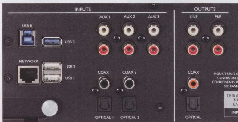
Ein Bild sagt mehr als tausend Worte: Hier sehen Sie die gesamte Anschlussabteilung des M6 Encore 225. Die auffällige Schraube unten links versiegelt den Schacht der austauschbaren 2-TB-Festplatte. Nicht im Bild sind die Lautsprecheranschlüsse.
