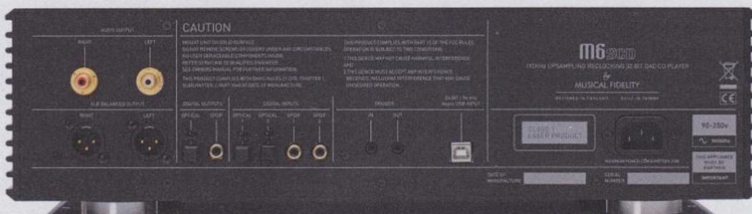
Zusätzlich zu den Standard-Ausgängen offeriert der M6scd darunter ein Paar symmetrische Ausgänge, die im Zweifel wegen des theoretisch besseren Störspannungsabstands vorzuziehen sind. Der USB-Eingang akzeptiert hier nur 96 kHz, während die koaxialen S/PDIF-Kontakte bis 192 Kilohertz reichen. Passende USB-Treiber für Windows sind unter [www.musicalfidelity.com](http://www.musicalfidelity.com) unter „Support“ zu finden.
