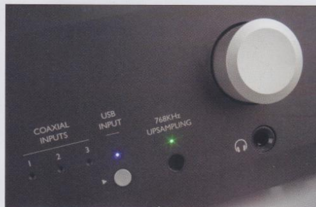
Bei seiner Arbeit zeigt der Wandler das laufende Upsampling auf 768 kHz stolz mit einer eigenen LED an
