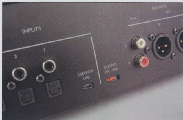
Mit dem roten Schalter lässt sich der M6s vom linearen in den variablen Ausgangsmodus schalten
