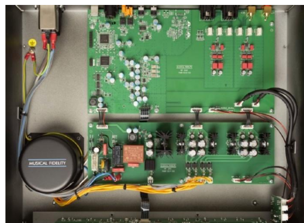
Der luftige Innenaufbau des M6x DAC mit dem großen »Super Silent«-Transformator links im Bild.
