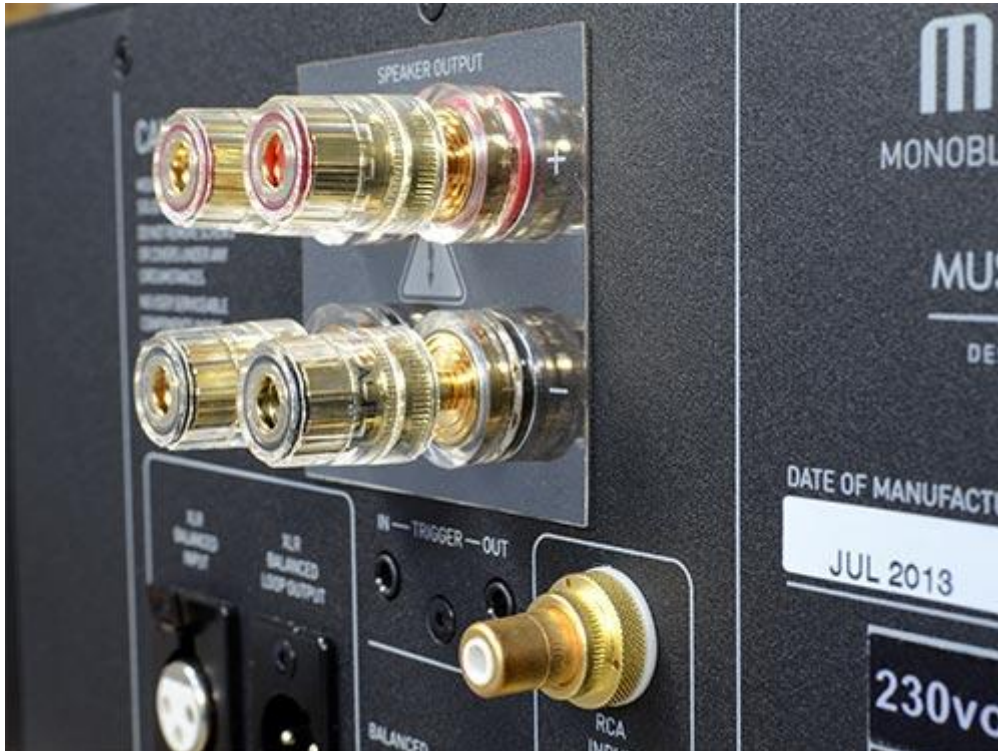
Unnötig eng verbaut: Das in doppelter Ausführung vorhandene Lautsprecherterminal der M8-Monoendstufen
