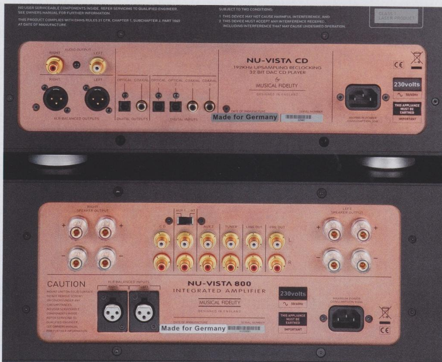
▲ Verkupferte Rückseiten, hochwertige Buchsen; der Player ist zugleich ein hochwertiger D/A-Wandler.
