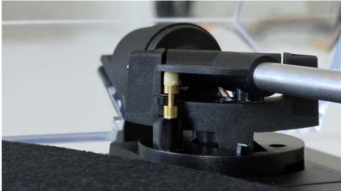
*Tonarmlift: Ein gedämpfter Stempel drückt gegen die Platte am Tonarm (Foto: R. Vogt)*
