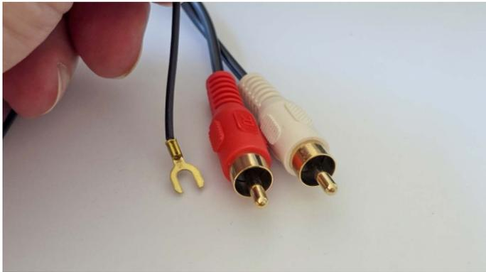
*Das schlichte Cinchkabel mit Masseleitung bietet immerhin vergoldete Kontakte (Foto: R. Vogt)*
