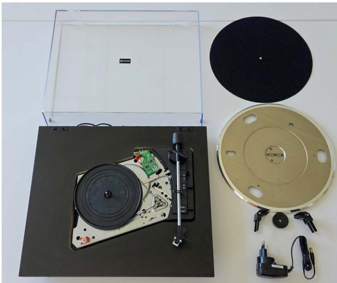
*Der Rekkord F110P kommt nahezu einsatzbereit aus dem Karton: Nur Teller auflegen, Haube mit Scharnieren einstecken – fertig (Foto: R. Vogt)*
