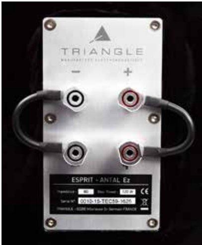
Blick auf die Anschlüsse auf der Rückseite und die wertige Bi-Amp-Brücke
