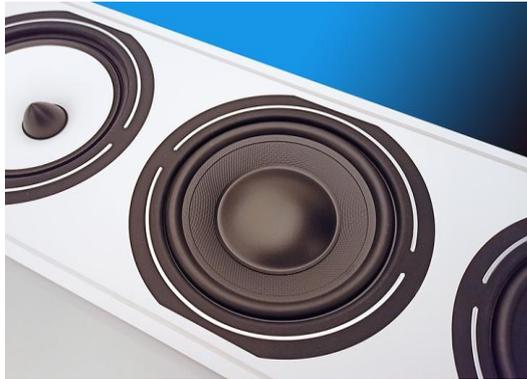
Die Konusmembran dieses 16-Zentimeter-Treibers wird aus Zellulosebrei geformt, wobei der noch flüssigen Masse Glasfasern beigemischt werden, um nach vollendeter Trocknung eine hohe Verwindungssteifigkeit des Verbundmaterials zu erzielen.
