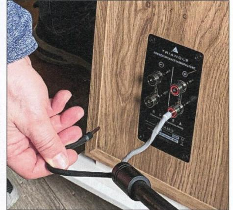
Das Bi-Wire-Terminal ist stabil und akzeptiert Bananas, Kabelschuhe und blankes Kabel.
