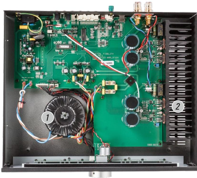
*Ein groß angelegter Ringkerntrafo <sup>1</sup> versorgt den Verstärker geräuscharm mit Energie. Die Kühlrippen <sup>2</sup> sind für den ausgezeichneten ClassAB-Verstärker von Nöten, um die Betriebstemperatur zu mindern und die Lebensdauer zu erhöhen*
