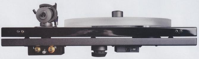
In der Seitenansicht ist der mehrschichtige Aufbau gut zu erkennen. Die Sorbothan-Kegel, welche die Platten voneinander trennen, dämpfen die Übertragung von Nebengeräuschen hervorragend
