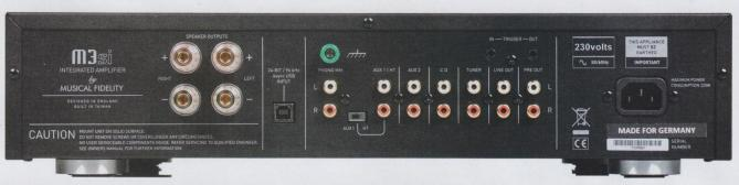
Der Verstärker besitzt keine Digitaleingänge, dafür aber einen USB-Anschluss. Er kann also direkt als Wandler genutzt werden. Darauf haben wir in diesem Test jedoch verzichtet und den M3si als reines Analogobjekt betrachtet
